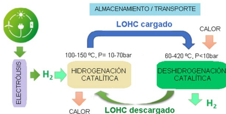
Figura. 9: Esquema de uso de LOHC [53]
